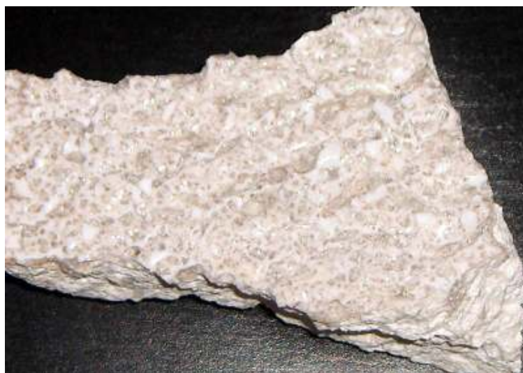
Figura 4.2 - Foto superior de um pedaço do cadinho atacado pelo vidro
