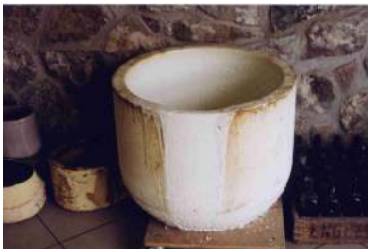
Figura 2.6 - Cadinho de 80L, idêntico ao utilizado no forno.
