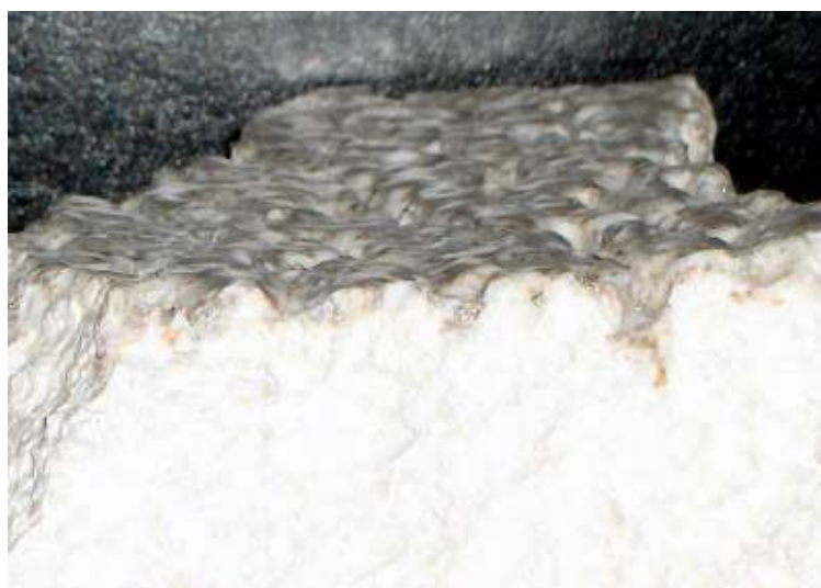
Figura 4.3 - Foto frontal de um pedaço do cadinho atacado pelo vidro
