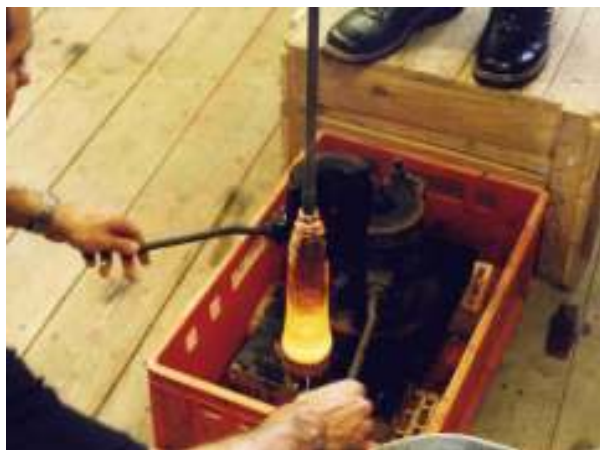
Figura 2.3 - Sopragem do vidro na forma de ferro fundido
